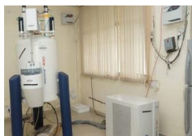
FT-NMR Spectrometer (400MHz Bruker)
